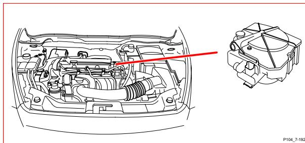
7/193 Lägesgivare turbo
