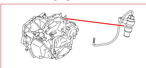
7/77 Temperaturgivare insugningsluft 1
