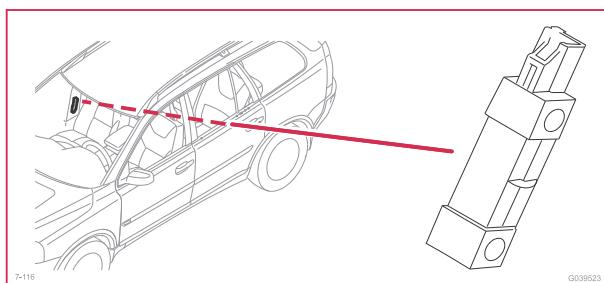
7/120 Vinkelgivare Four-C/Dual Xenon bak vänster
