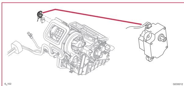
6/103 Styrenhet spjälmotor (DMM), golv/ventilation
