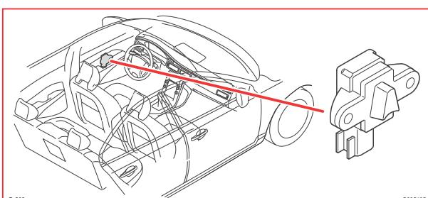
7/240 Batteriövervakningssensor (BMS)
