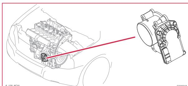
**6/103 Styrenhet spjälmotor (DMM), golv/ventilation**
